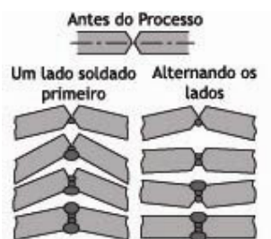
Figura 2. 23 - Comparação entre métodos de solda (Adaptado de Kou, 2003)
