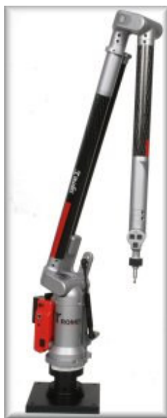
Figura 2. 24 - Medidor tridimensional da Romer (Romer, 2007)
