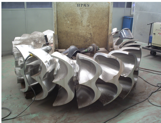
Figura 3. 3 - Bloco principal da turbina
